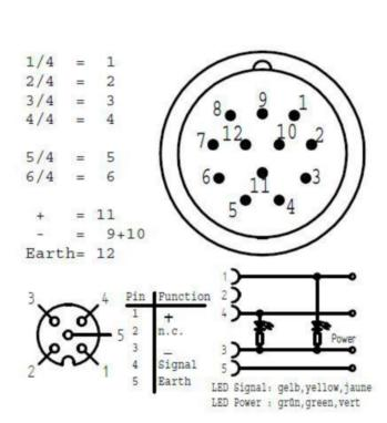
Kontaktbelegung I wiring diagram affectation des contacts
