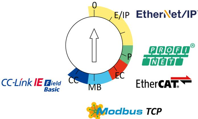
Über die anderen Drehkodierschalter (x10 / x1) legen Sie die letzten zwei Stellen der IP-Adresse fest, wenn Sie EtherNet/IP, Modbus TCP oder CC-Link IE Field Basic verwenden.
