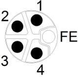
Abb. 7: Schemazeichnung M12 L-Kodierung (Stecker X03 für Power In)
