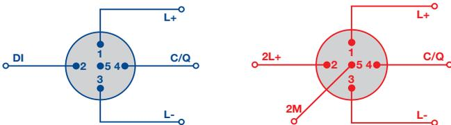
IO-Link Class A-Ports (X1-X4) eignen sich am besten für Sensoren, weil sie neben dem üblichen Pin 4 (IO-Link Kommunikation) einen zusätzlichen festverdrahteten Digitaleingang (DI) auf Pin 2 haben. Dies ermöglicht die Erfassung von zwei verschiedenen Signalen pro Port, indem z.B. ein T-Stück verwendet wird.
