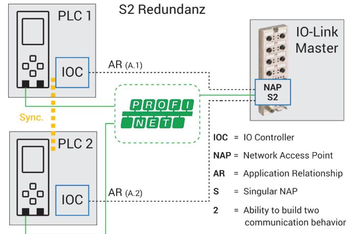
S2-Redundanz ist ein auf der Profinet-Signalübertragung basierender Mechanismus, der es ermöglicht, dass der IO-Link Master LioN-P an zwei verschiedene Steuerungen angeschlossen werden kann. Dies ermöglicht die Übertragung von Sensor- und Aktorsignalen von der Feldebene über den IO-Link Master zu zwei redundanten Profinet Steuerungen und führt zu einer höheren Maschinenverfügbarkeit.
