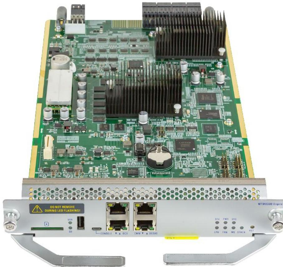
引擎模块是 MTS8006 交换机中最重要且必备的板卡，其作用是作为设备的控制中心。每个机框至少使用一张引擎模块，可以同时支持两张，实现 1:1 备份的工作方式。引擎模块作为配件提供。请参阅第 21 页的“订购号”。
