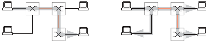
Abb. 36: MAC-Datenvermittlung: Unicast-Datenpaket (links) und Broadcast-Datenpaket (rechts)
