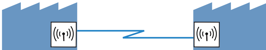
Abb. 2: Wireless-Verbindung zwischen 2 Access Points
