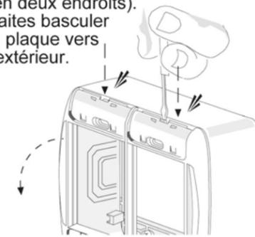
4.2 Pour séparer le boîtier adaptateur de la plaque arrière, insérez un petit tournevis dans l'encoche entre la plaque arrière et le boîtier. Faites basculer vers le centre (en quatre endroits). Tirez le boîtier adaptateur vers l'extérieur.
