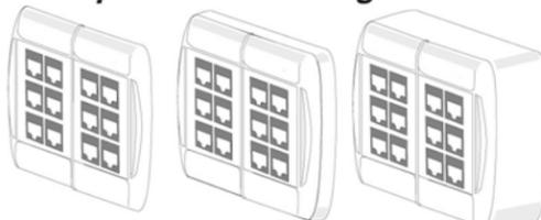
Montage encastré Montage sur anneau d'espacement (Boîtier double seulement) Montage sur boîtier
