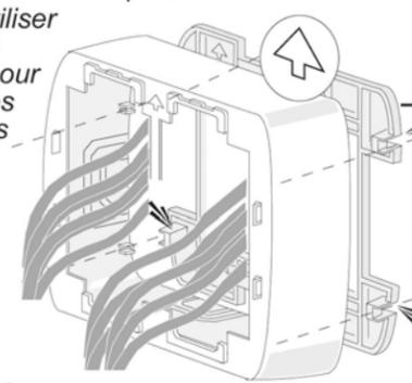
3.5 Insérez la plaque dans le boîtier adaptateur.
