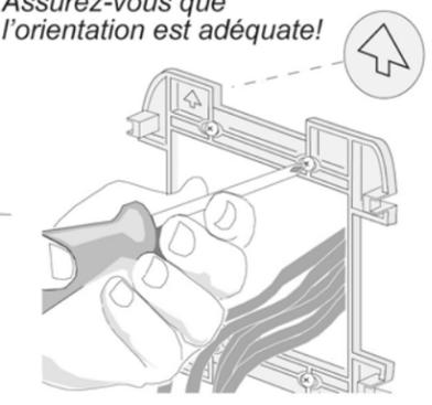
3.3 À l'aide de pinces coupantes et d'un couteau, retirez les pattes des côtés pour convenir à la dimension et à l'orientation de tout câble ou toute canalisation à montage en surface.
