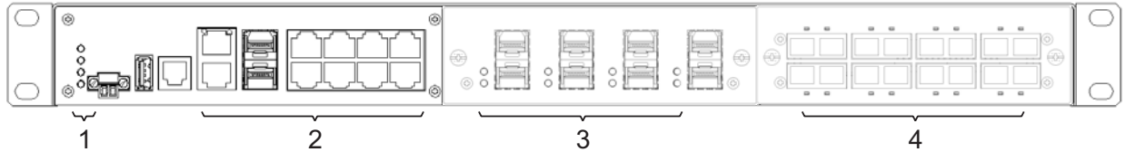
Abb. 23: MACH102-Anzeigeelemente 1 - Anzeigeelemente für den Gerätestatus 2 - Anzeigeelemente für den Port-Status 3 - Anzeigeelemente für Port-Status, Medienmodul 1 4 - Anzeigeelemente für Port-Status, Medienmodul 2
