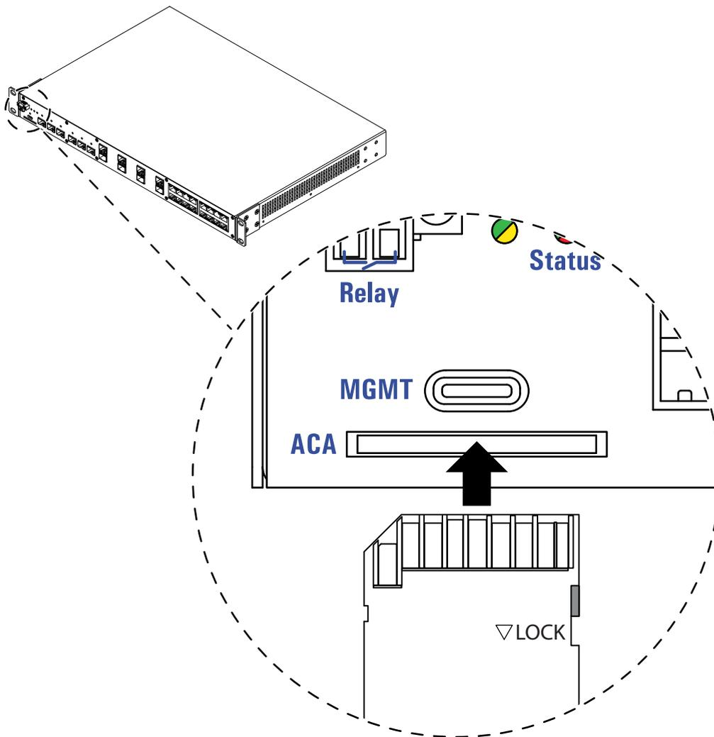
Abb. 1: Installation des Speichermediums ACA31 am Beispiel GRS105/106
