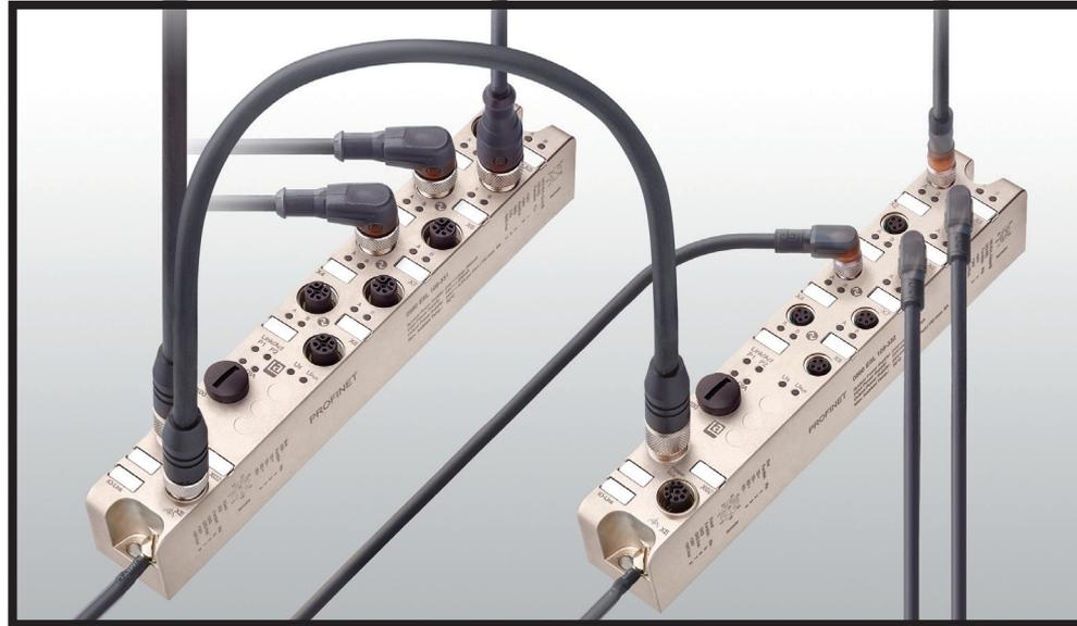
**Im Unterschied zu klassischen E/A-Modulen mit zwei Ports für Daten und zwei für Leistung kombinieren hybride E/A-Module Daten und Leistung in einem Port, wodurch sie kompakter sind.**
