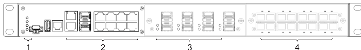
Abb. 22: MACH102Anzeigeelemente 1 - Anzeigeelemente für den Gerätestatus 2 - Anzeigeelemente für den Portstatus 3 - Anzeigeelemente für Portstatus, Medienmodul 1 4 - Anzeigeelemente für Portstatus, Medienmodul 2
