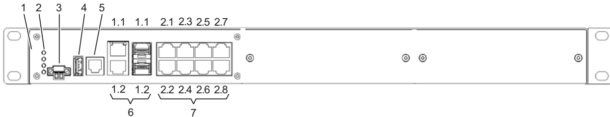
Abb. 2: Übersicht Schnittstellen, Anzeige- und Bedienelemente beim MACH102-8TP-F und MACH102-8TP-FR 1 - MACH102-Gerät 2- LED-Anzeigeelemente 3 - Meldekontakt 4 - USB-Schnittstelle 5 - V.24-Zugang für externes Management 6 - Siehe folgende Tabelle, Spalte 1 7 - Siehe folgende Tabelle, Spalte 2
