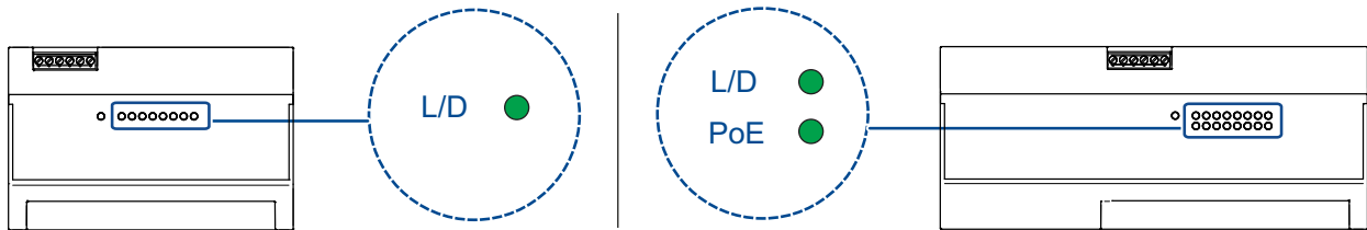
Abb. 6: LED-Anzeigeelemente für Port-Status
