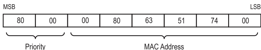
Abb. 43: Bridge-Identifikation, Beispiel (Werte in Hexadezimalschreibweise)
