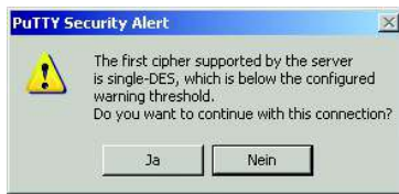
Abb. 80: Sicherheitsabfrage zur eingestellten Warnschwelle
